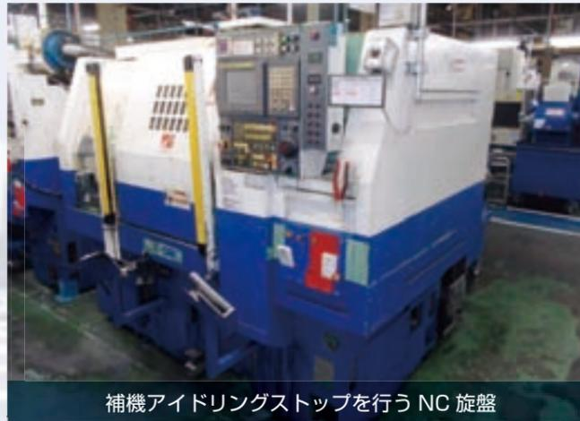
補機アイドリングストップを行うNC旋盤
