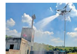
消防用ドローン
