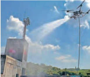
消防用ドローン
