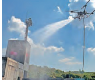
消防用ドローン
