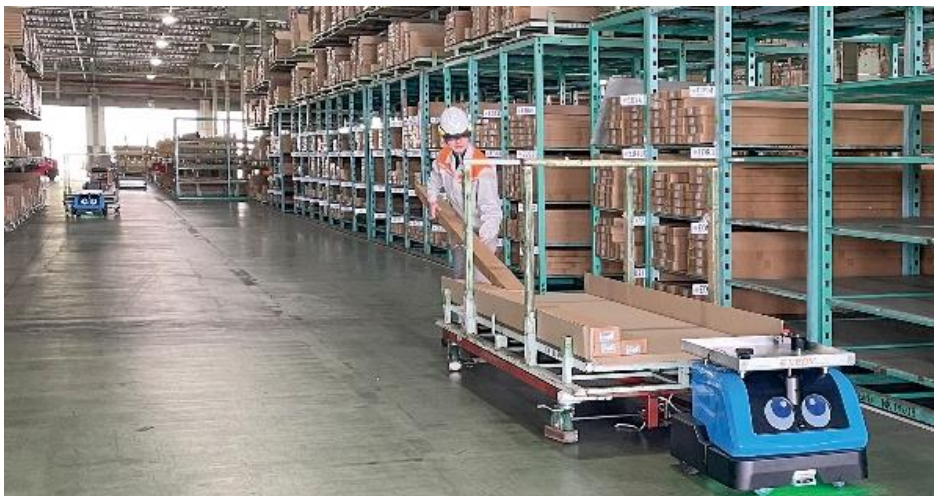
株式会社LIXIL物流 岡山物流センター様倉庫での実証実験の様子
